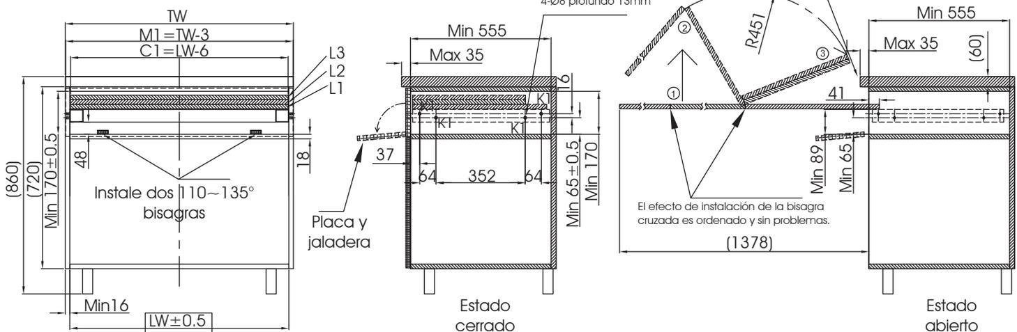
TW=Ancho exterior del gabinete TW=Profundidad interna del gabinete
