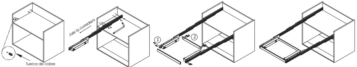
1. En el orificio previamente perforado, vuelva a perforar y golpee la tuerca del tornillo de fijación.
