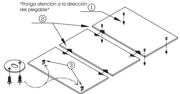
7. Golpee la tuerca del tornillo de fijación en la parte posterior de la placa fija, instale la bisagra transversal entre las placas plegadas e instale el pestillo de bloqueo en la parte posterior de la placa plegada 3
