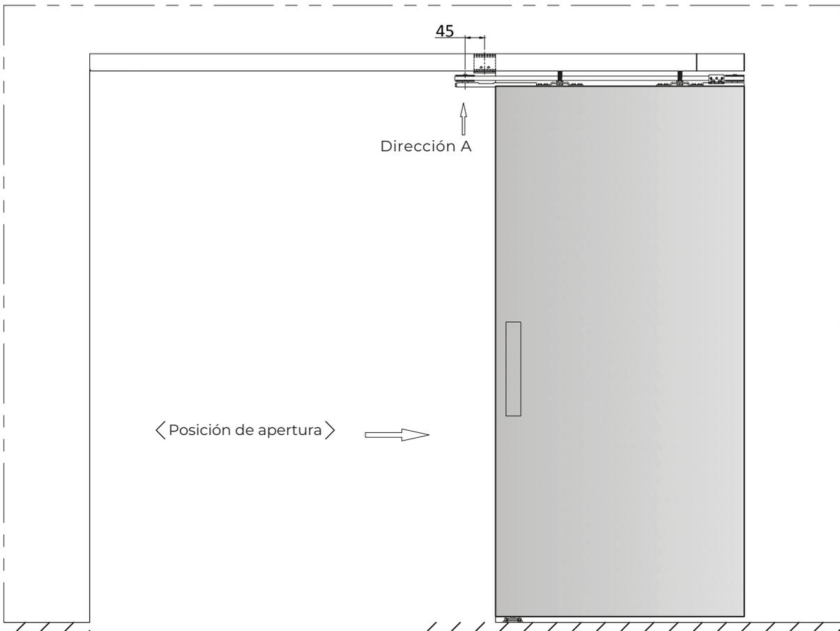
2) En el estado de apertura, mueva la abrazadera en L a la posición que está a 45 mm del centro de la rueda de placa larga.
