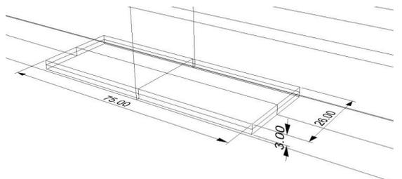
Hacer un corte en la parte inferior, para el Pivote "A" inferior, con las siguientes medidas.
