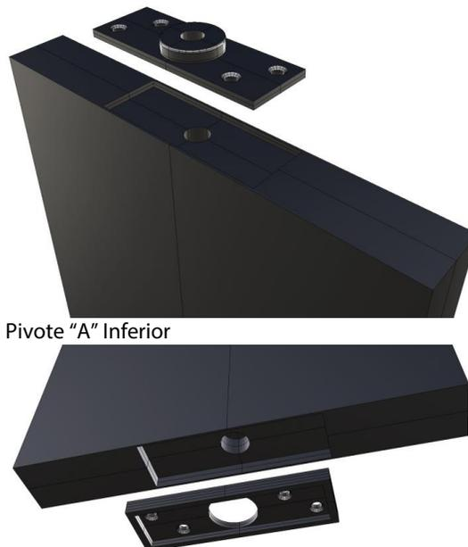
Paso 2. Colocar la contra con Pin Extendido del pivote superior.
