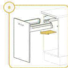
Desmonte las correderas
