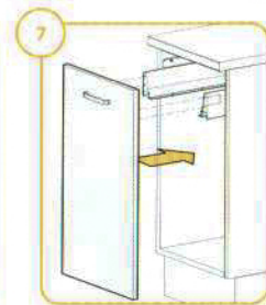
Monte la puerta a las correderas
