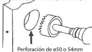
Perforación de \varnothing 50 o 54mm
