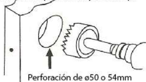
Perforación de \varnothing 50 o 54mm
